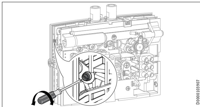
► Réglez le débit volumique maximal souhaité à l'aide de la vis de réglage :
